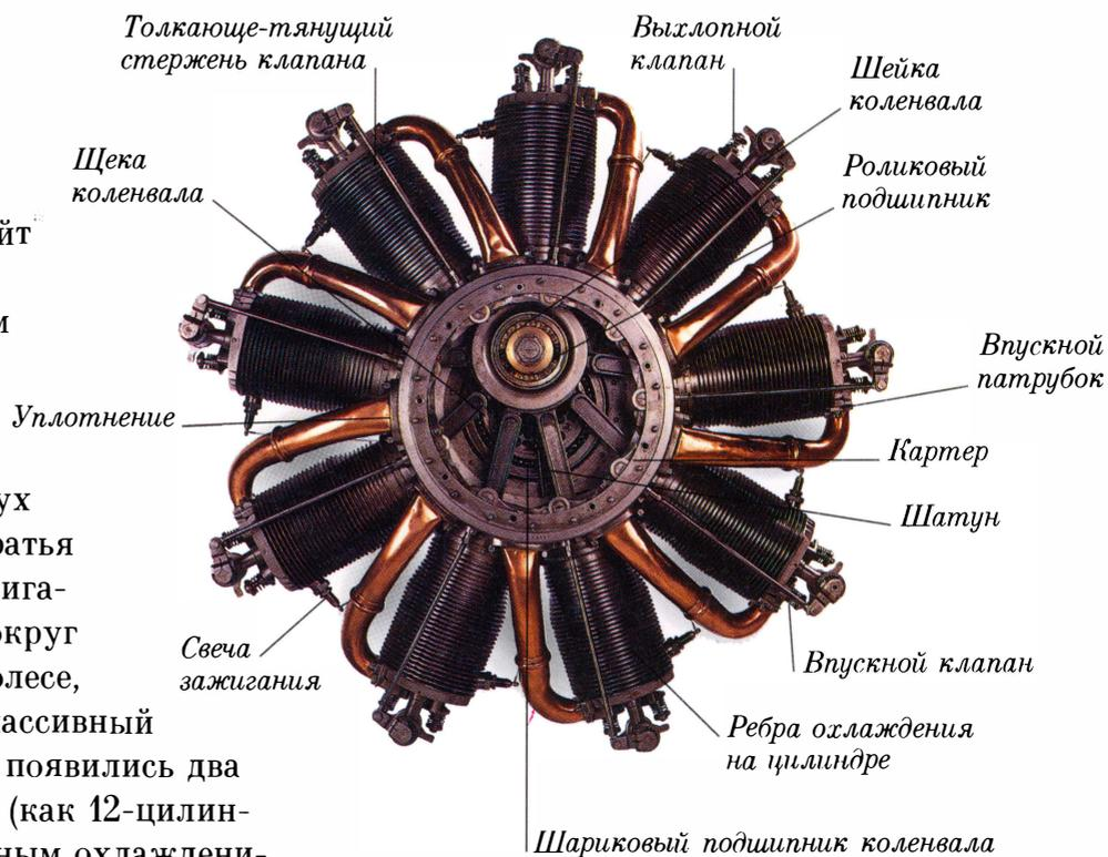
ДЕТАЛИ ЦИЛИНДРА РОТАТИВНОГО ДВИГАТЕЛЯ «ГНОМ» (100 л.с.), 1914 г.
